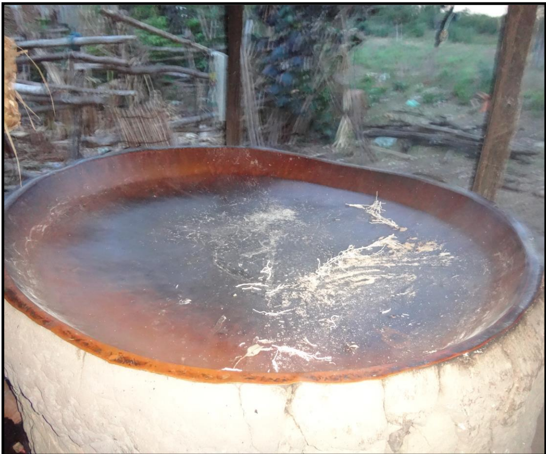
Figura 64. Forno de torrefação para fabricação da farinha, na comunidade Jurussaca Fonte: Autora da pesquisa
